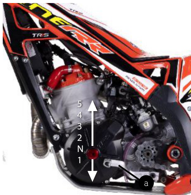
a) Gear shift lever
