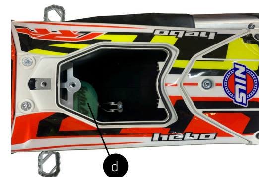
c) Air box baffle.
