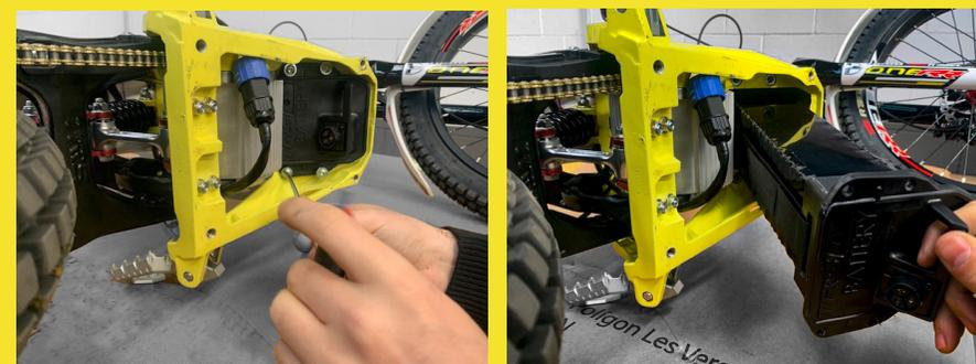
A continuación desenroscamos los tornillos de la tapa plástico batería con una llave de tubo de 8mm y extraer la batería tirando por la manija.
