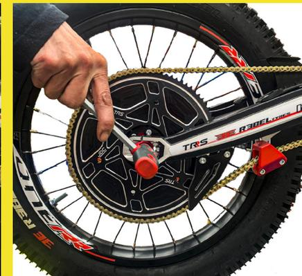
Desatornillar el eje de la rueda trasera con una llave allen de 8mm.
