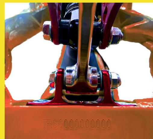
**A)** Posición del número de identificación grabado en el bastidor, ubicado entre el basculante, chasis y la bieleta.
