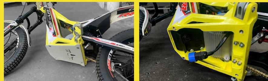
Tumbamos la moto en el suelo y con una llave allen de 5mm, sacar los 4 tornillos de la placa protectora inferior del chasis y desconectar el conector girando el pomo azul en sentido antihorario.
