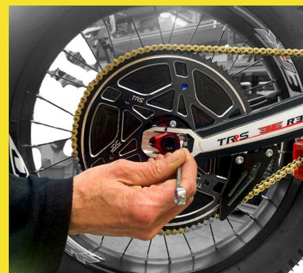
Desatornillar el tensor cadena con una llave fija de 5mm empujando el tensor de la cadena. Realiza la misma operación en el otro lado del basculante. Fijar las contratuercas y atornillar el eje de la rueda. Comprobar que el piñón y los tornillos de la corona están correctamente atornillados.
