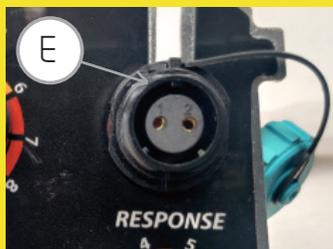
Fig E) Conector de carga
