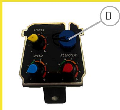
Debajo del asiento se encuentra el conector para el cargador (Fig D), desenroscamos el tapón azul y enchufamos primero la clavija del cargador a la moto y luego lo conectamos a la red.
