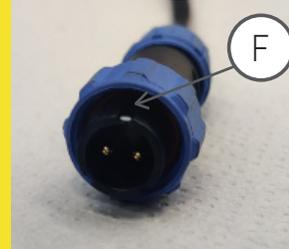
Cuando la batería está totalmente cargada, desconectar el cargador de la red así como el conector a la moto, en este orden. Roscar el tapón del conector del cargador y la moto está lista para su uso.
