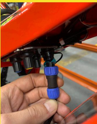
Posicionar correctamente la clavija de dos pines (fig F) alineando el punto blanco con la hendidura que sobresale del conector de carga (fig E) de la ON-E. Enroscar la tuerca que trae la clavija de dos pines (fig D). Volver a poner el tapón azul, cuando la batería éste completamente cargada.
