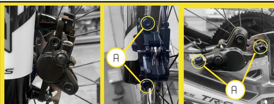
Usando la llave allen de 5mm, aflojamos los dos tornillos (A) de la pinza de freno delantera y/o trasera.
