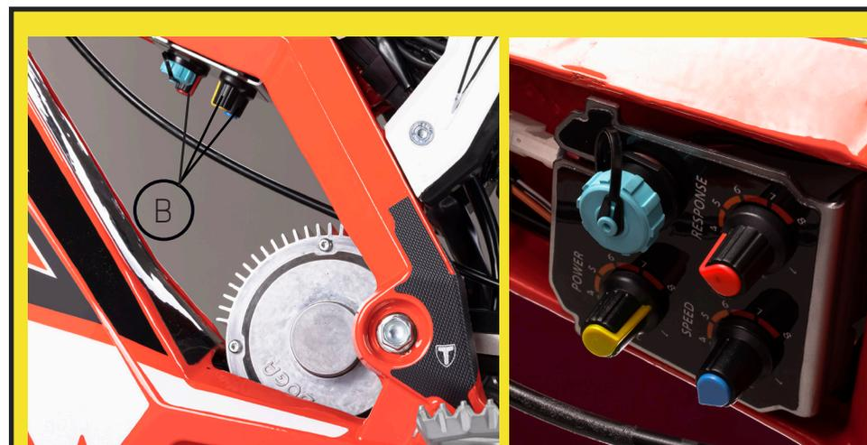
Fig. B) Reguladores se encuentran en la parte interior del chasis y permiten variar la potencia (amarillo), la velocidad (azul) y la respuesta (rojo). Los reguladores girando en sentido a las agujas del reloj, las prestaciones de la motocicleta aumenta. Al contrario, girando en sentido antihorario las prestaciones se reducen al mínimo
