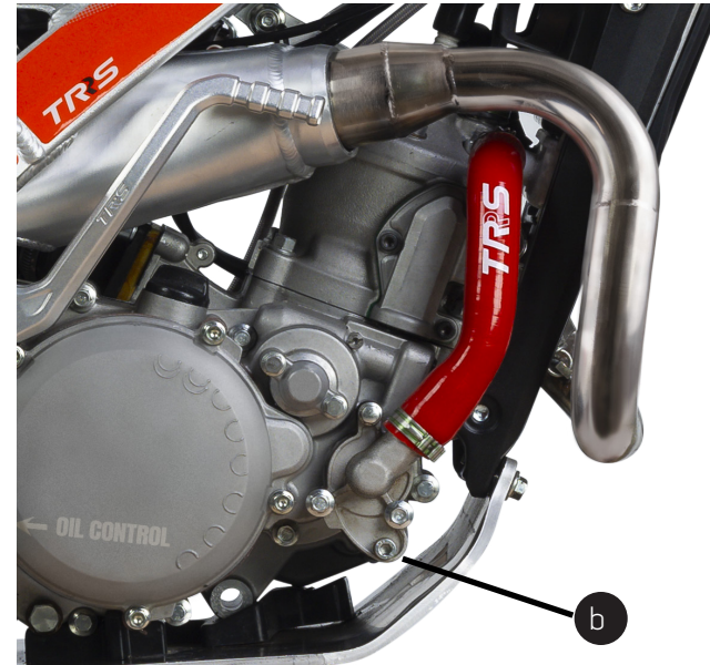
b) Tornillo para el vaciado del agua de refrigeración situado en la tapa de la bomba de agua.
