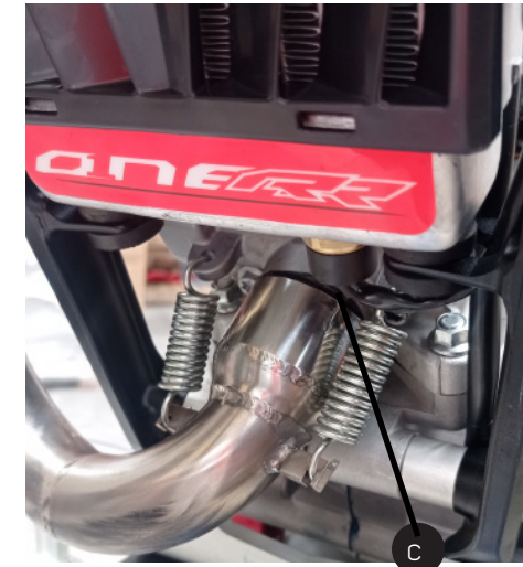
c) Termocontacto, atornillado al ventilador
