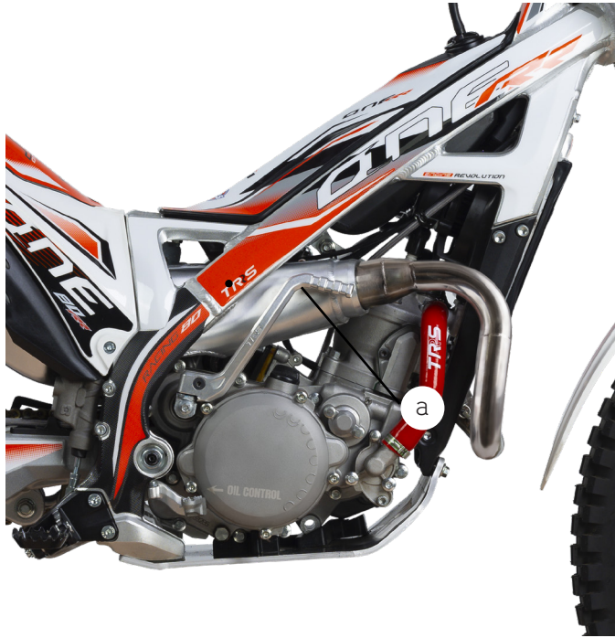
a) Palanca Arranque, en el lado derecho de la TRS RR 80cc
