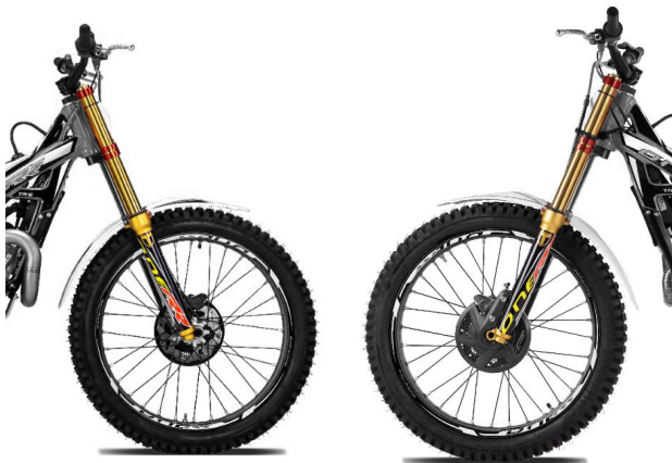
a) En el lado derecho de la suspensión podemos ajustar la extensión
