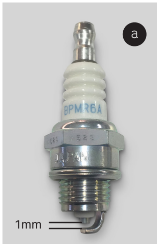
a) La bujía que viene instalada de fábrica es la definida en la hoja de características. Debe apretarse a 11Nm.
