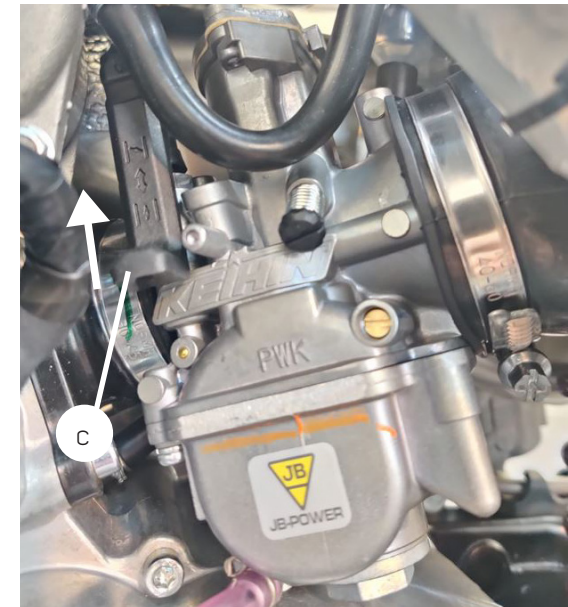
c) Estárter, en el carburador Keihin
