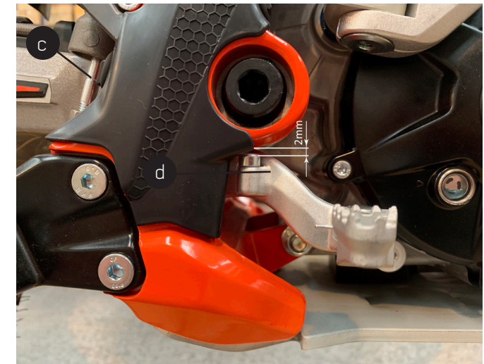
c) Varilla tensor pedal freno trasero; d) Tornillo para ajuste de la altura del pedal de freno. Hay que dejar un poco de juego muerto para un buen funcionamiento.
