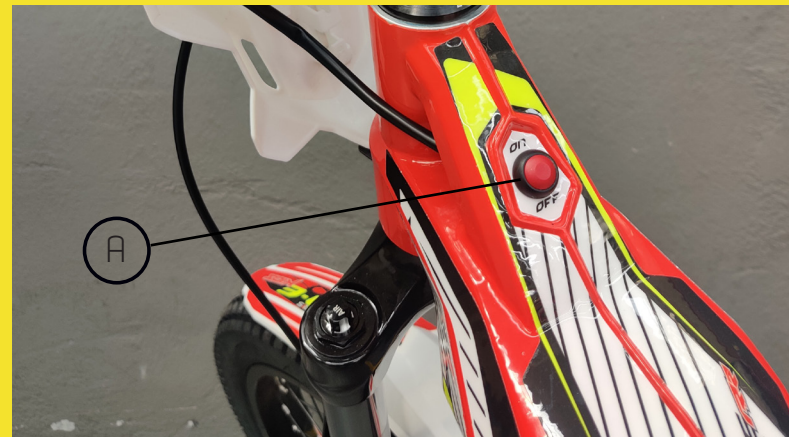
Fig A) Interruptor ON /OFF ubicado en la parte superior del chasis
