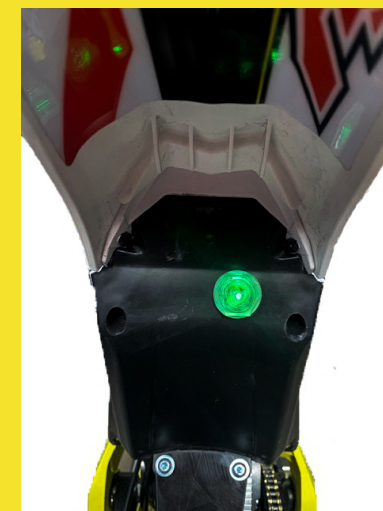
D) Mirilla indicadora, indica si la motocicleta está en marcha. Si tiene un funcionamiento normal estará en verde y un funcionamiento erróneo o sin batería en rojo.
