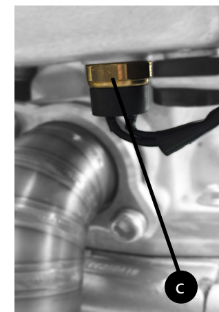
c) Termocontacto situado en la parte inferior del radiador.
