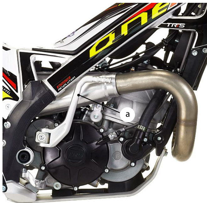
a) Palanca Arranque, en el lado derecho de la TRS One
