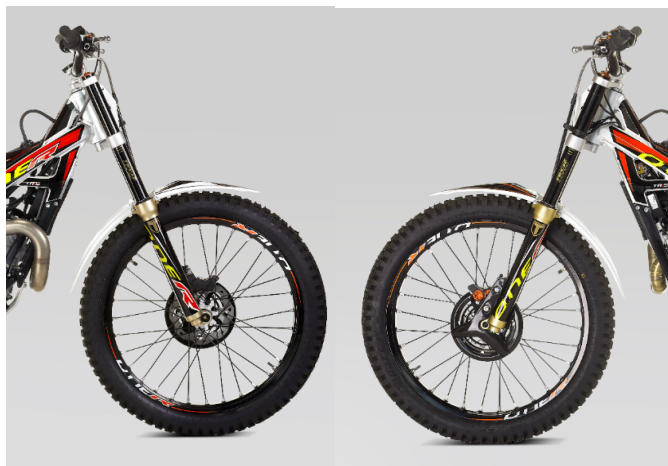
a) Precarga del muelle; b) Compression ajustable
