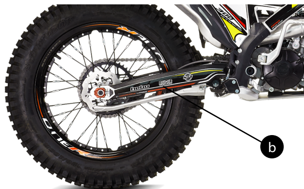
b) ¡Importante! Es importante realizar el mantenimiento periódico del basculante y de la suspensión trasera.
