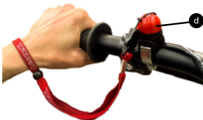
d) Desconectador o Hombre al agua, situado a la izquierda del manillar Es un elemento de seguridad, con lo que, en caso de caída del piloto, la moto se desconecta. Asegurarse que el piloto se coloca la cinta elástica en la muñeca izquierda y queda firmamente sujeta , antes de encender el motor
