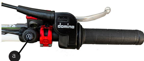
a) Botón arranque eléctrico, situado a la derecha del manillar
