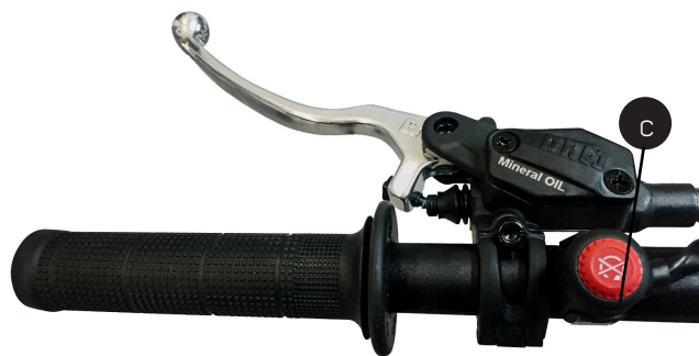
c) Botón Paro, situado a la izquierda del manillar El botón de paro se encuentra situado en el lado izquierdo del manillar, accesible a nuestro dedo pulgar para poder accionarlo con facilidad.
