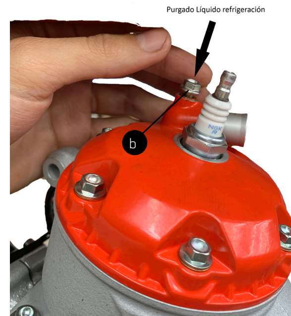
b) Tornillo purgador del líquido refrigerante, situado en la parte superior de la culata.
