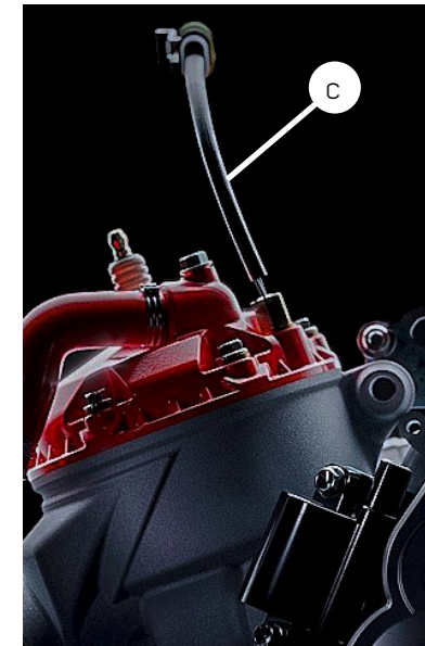
c) Sensor de temperatura, atornillado en la tapa culata.
