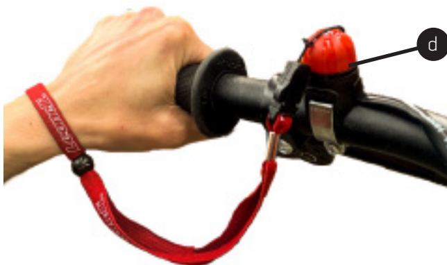
c) Botón Paro, situado a la izquierda del manillar El botón de paro se encuentra situado en el lado izquierdo del manillar, accesible a nuestro dedo pulgar para poder accionarlo con facilidad.
