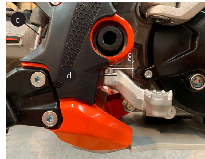
c) Varilla tensor pedal freno trasero; d) Tornillo para ajuste de la altura del pedal de freno. Hay que dejar un poco de juego muerto para un buen funcionamiento.
