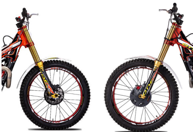
a) En el lado derecho de la suspensión podemos ajustar la compresión
