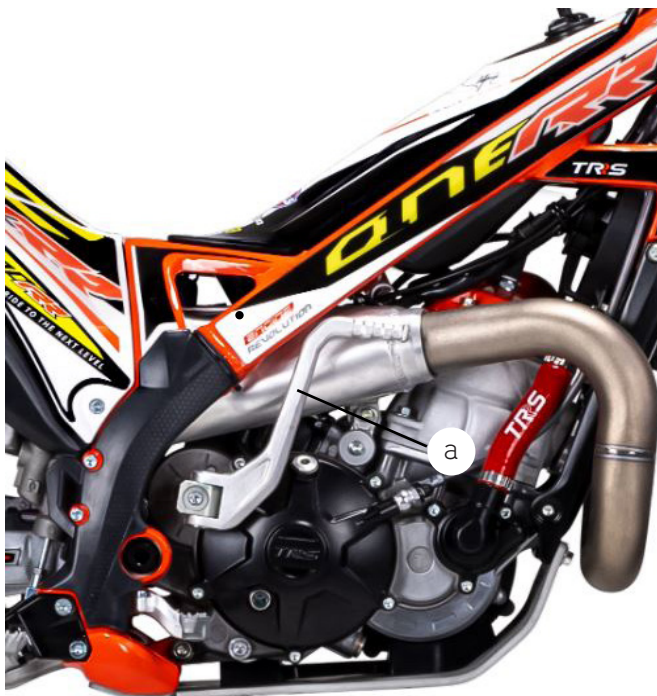
a) Palanca Arranque, en el lado derecho de la TR5 One
