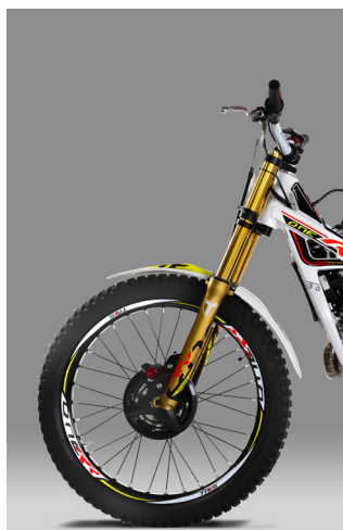
b) En el lado izquierdo de la suspensión podemos regular precarga del muelle.
