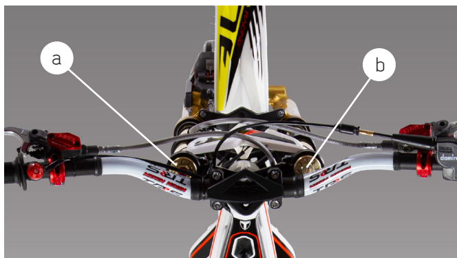
a) Precarga del muelle; b) Regulación de la extensión
