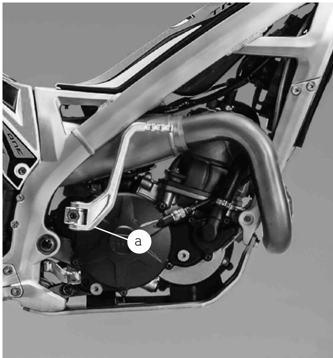
a) Palanca Arranque, en el lado derecho de la TRS One
