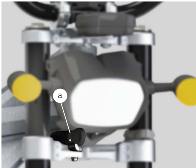
a) El sistema clausor está situado debajo del faro
