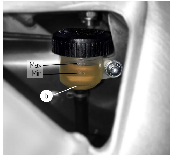
b) Depósito de freno trasero
