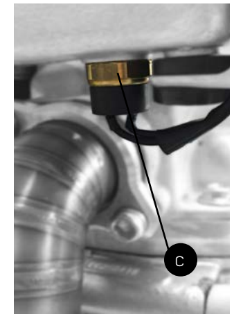
b) Termocontacto situado en la parte inferior del radiador.
