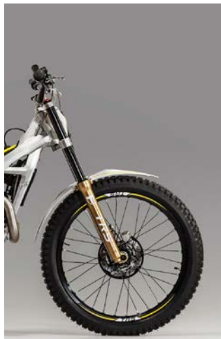
a) En el lado derecho de la suspensión podemos regular la extensión.
