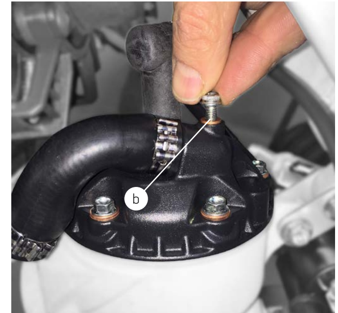
b) Tornillo purgador del líquido refrigerante, situado en la culata.
